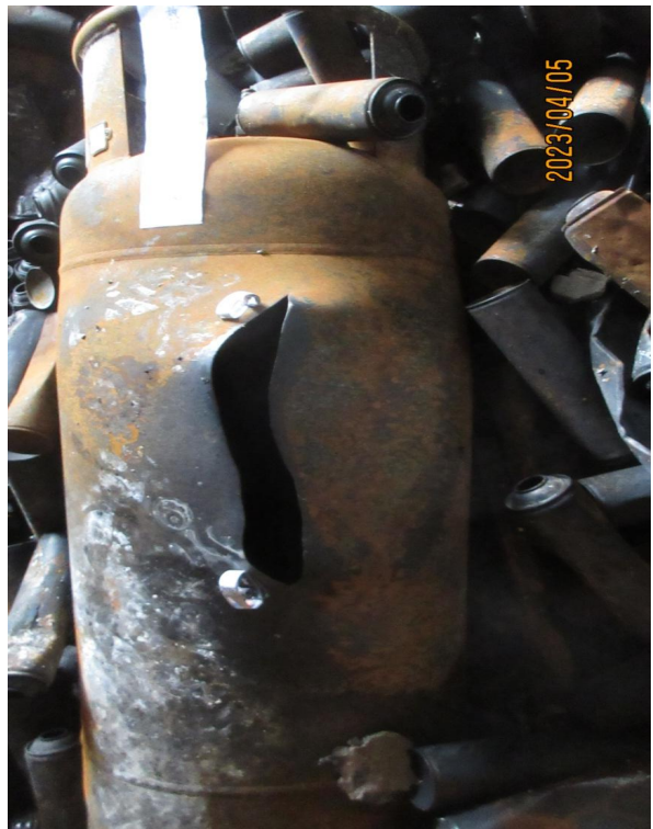
图 6 现场发生物理爆炸的液化石油气瓶
