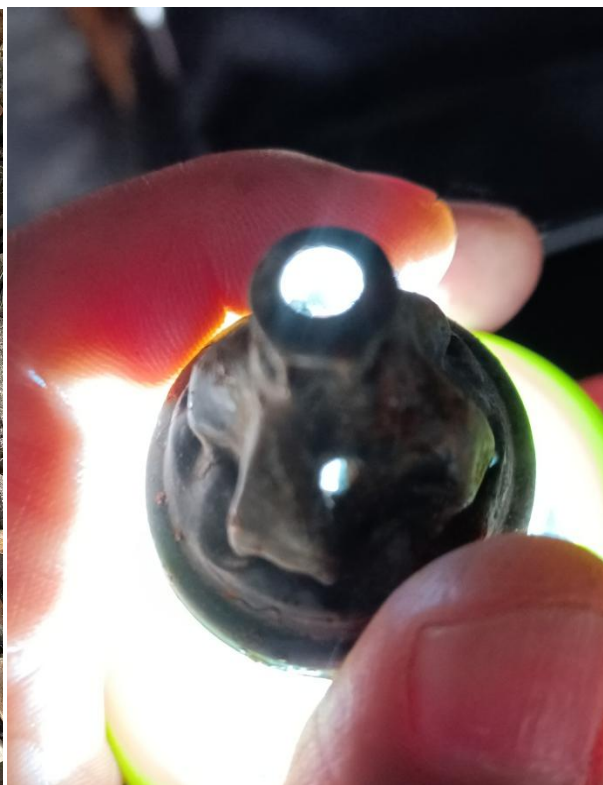
图 13 经戳孔、拔出的发胶罐密封盖
