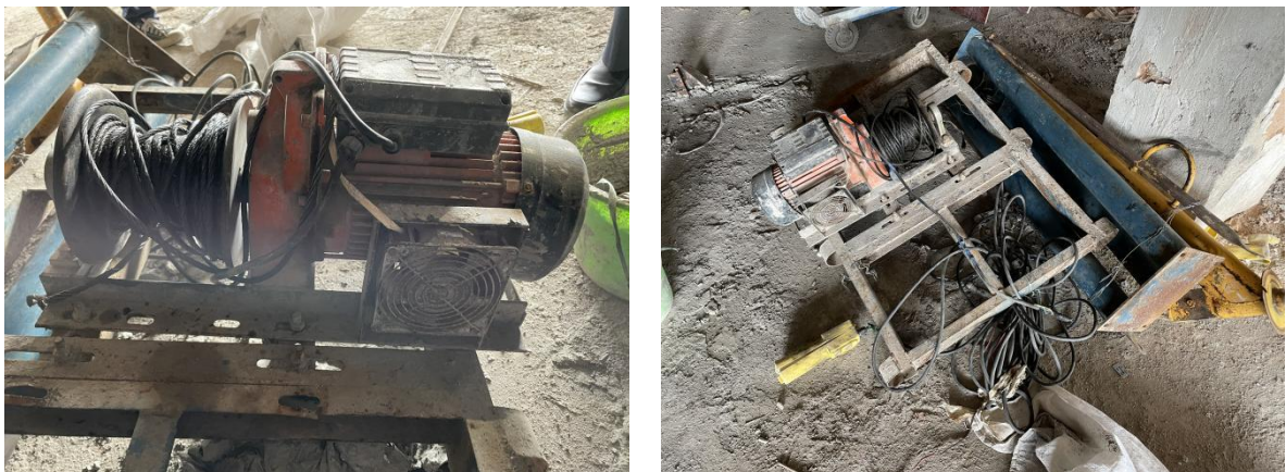
图5 事发时使用的简易吊机
