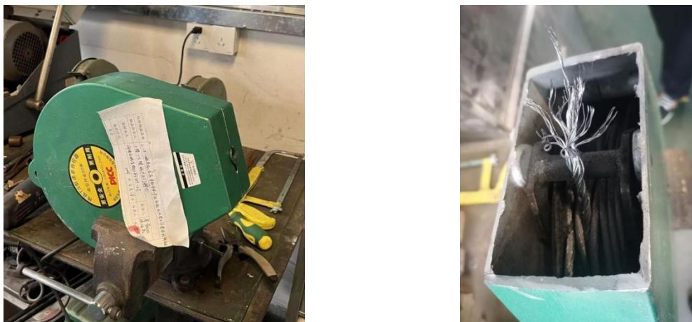
图 34 防坠器拆解情况（钢丝绳绳头散股）
