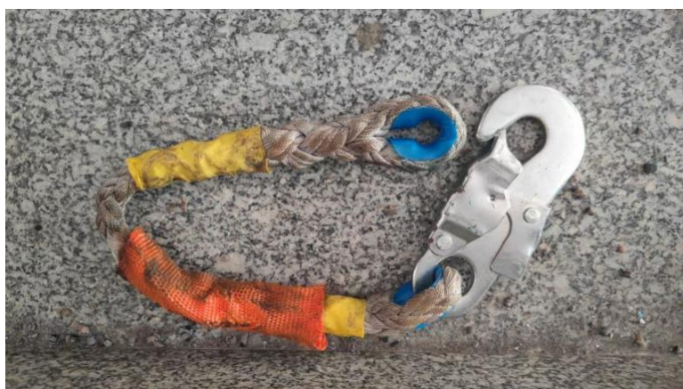
图 29 吊笼主钩及事发时使用纤维绳
